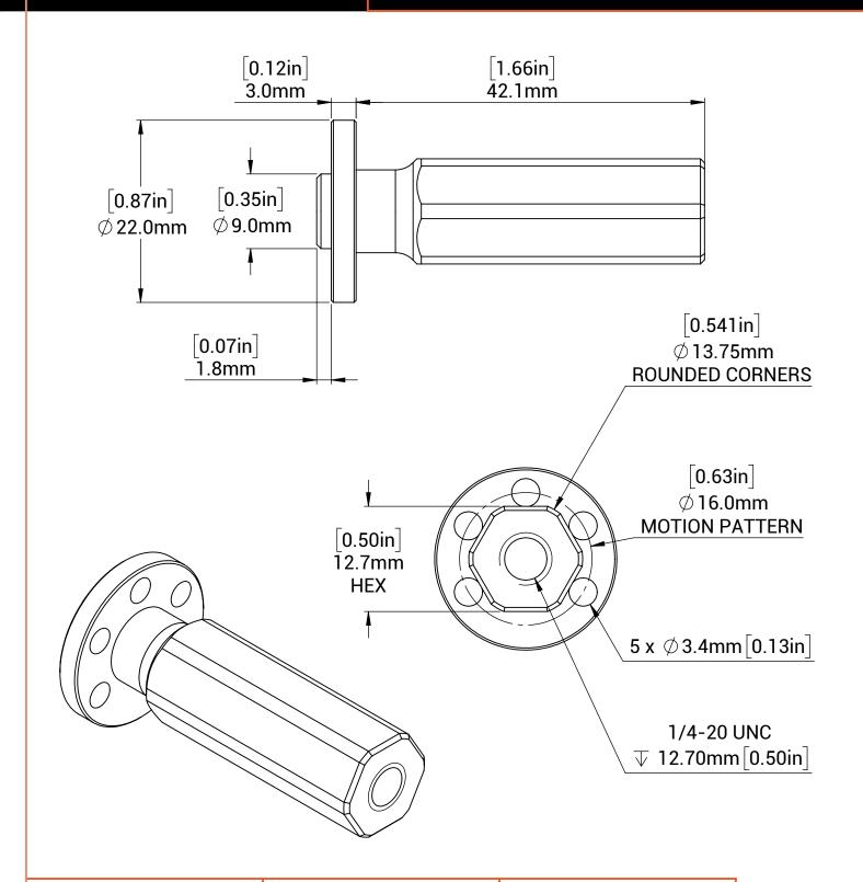
MM SHEET TOLERANCES:  $X \pm 0.50$  MM  $X.X \pm 0.10$  MM  $X.XX \pm 0.05$  MM  $X.XX \pm 0.05$  MM ANGLES  $\pm 2^{\circ}$
